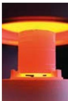
Chauffage homogène du cylindre
